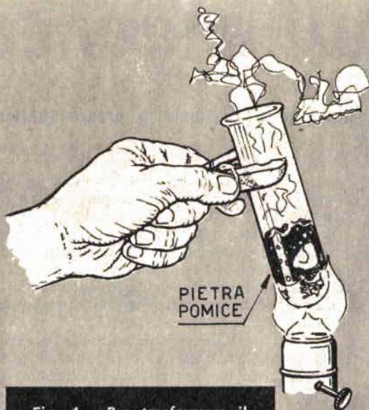
Fig. 4 - Per trasformare il piombo in... argento occorre prima introdurre in una provetta ben asciutta alcuni pezzetti di piombo e portare la stessa sopra la fiamma fino ad ottenere la liquefazione del piombo.
